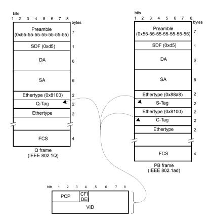
Figure 4.2: IEEE 802.1Q y IEEE 820.1ad frame structures.
