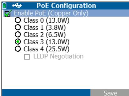
Abbildung 19. PoE-Konfiguration auf Modell LR-AT 1000
