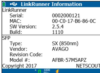
Abbildung 13. LinkRunner-Informationenbildschirm mit angeschlossenem Glasfaseradapter
