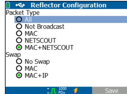
Abbildung 12. Bildschirm für Reflector-Standardkonfiguration
