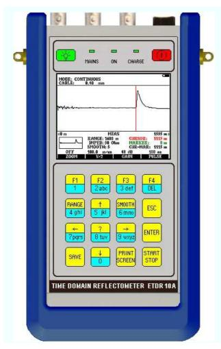
Die ETDR 10 AC war entwickelt für schnelle und genaue Fehlerortung und Qualifizierung von koaxialen Kabeln mit dem Impuls-Echo-Verfahren.
