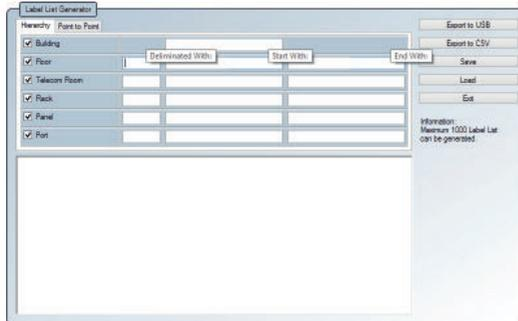
Der Kennzeichnungslistengenerator erstellt Kabelkennzeichnungen in anpassbarer hierarchischer Reihenfolge (Gebäude > Etage > Telekommunikationsraum > Rack > Panel > Port), noch bevor Kabelzertifizierungen ausgeführt werden. Dies erspart unnötigen Aufwand durch Eingabe von Kennzeichnungen nach jedem einzelnen Test. Die vordefinierten, in das Gerät importierten Kennzeichnungen verhindern doppelte Prüfungen, wenn die Prüfungen nicht der Reihe nach ausgeführt werden.
